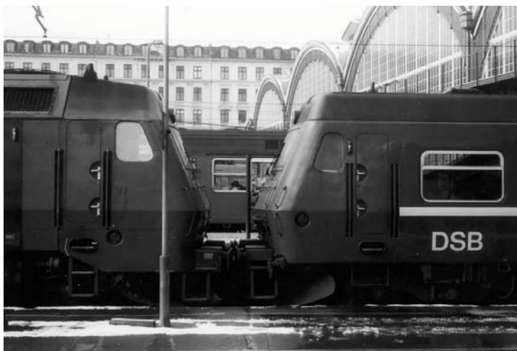
Bild 6 En manövervagn i ett prototyp- Lyntog, kopplad till ett dieselelektriskt ME-lokomotiv (till vänster). Bägge ändar av vagnsättet har samma utseende. Notera den enhetliga formgivningen, baserad på västtysk 70-talsdesign Foto: författaren, Köpenhamn centralstation, februari 1988
