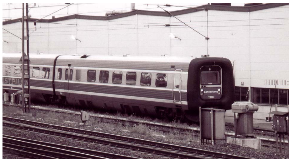
Bild 7 Den tredje generationen danska Lyntog, den här versionen dock i svensk tappning (littera Y2). En dansk IC3:a kostar cirka 41 mkr (prisnivå 2000), har en tomvikt på 97 ton och har sth 180 km/h. Tåget kan dock med lätthet modifieras för 200 km/h. Notera den enhetliga vagnprofilen och det inklädda underredet. Foto: författaren, Linköping, Östergötlands län, oktober 2003
