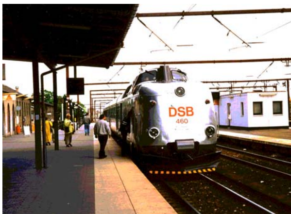
Bild 5 Den andra generationen Lyntog vid Roskilde. Tågsättet har sth 140 (160) km/h och kan smidigt delas på mitten. Lättviktslokomotivet (51 ton) har beteckningen MA och drivs av en 809 kW stark dieselmotor från Maybach. Ett trevagnarståg kostar cirka 35 mkr (prisnivå 2000). Den västtyska versionen modifierades senare genom att en gasturbin med effekten 1.619 kW installerades i lokomotivet. Lokomotivet på bilden har ej originalmålning. Foto: Steen L. Eriksen, Danmark
