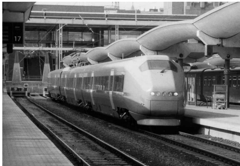
Bild 12 Ett regionaltåg av typen 71. Dess "systemversion" littera 73 har en vagn till, det vill säga fyra stycken. Bägge har sth 210 km/h. 71:an trafikerar endast regionaltågslinjen Sandvika- Gardermoen via Oslo city. Notera den eleganta infällningen av kopplet bakom en lucka. Totalt har trevagnarståget en tomvikt av 158 ton. Källa: författaren, Oslo augusti 2001
