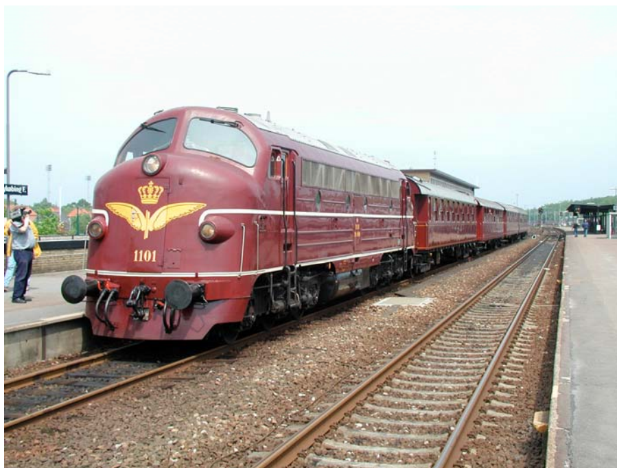
Bild 4 Ett diesellokomotiv av typen MY vid Nyköbing (Danmark), maj 2003. Loket har vikten 102 ton, sth 133 km/h och drivs av en amerikansk, tvåtakts dieselmotor med 12 cylindrar (V-12). Loktypen är den första från GM i reguljär trafik i Europa Foto: Stephan Seelemann, Hamburg
