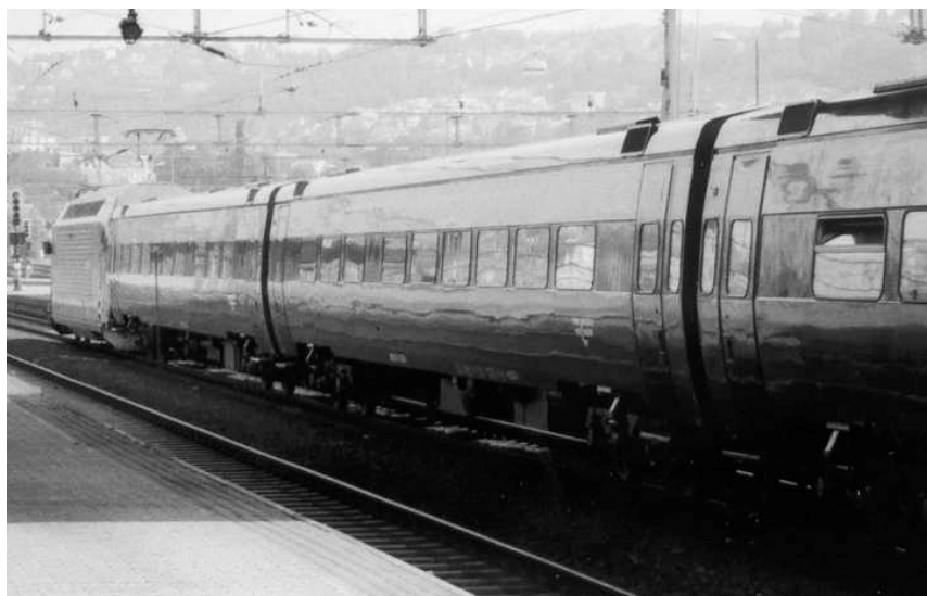
Bild 11 80-talsvagnar av typen x7, dragna av ett schweiziskkonstruerat, fyraxligt El 18-lokomotiv med sth 200 km/h. Vagnkorgarna är tillverkade av schweiziska lättmetallprofiler från Alusuisse och har sth 150 km/h. Både lok och vagnar har mjuka boggierna. Foto: författaren, Oslo, augusti 2001
