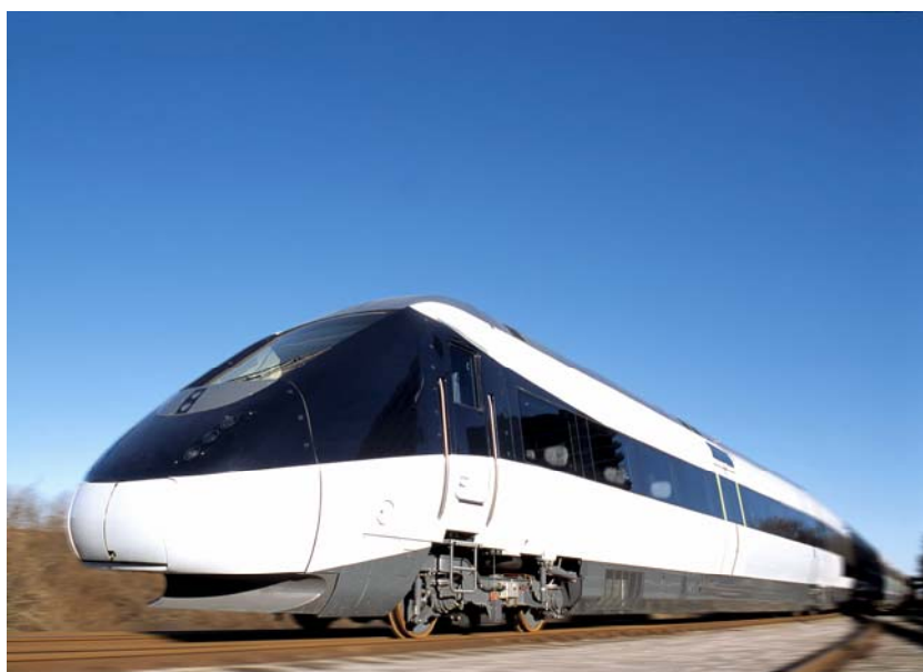
Bild 8 Det senaste danska motorvagnståget av typen IC 4. Tågsättet tillverkas i Italien och består av fyra personvagnar, väger 147 ton har sth 200 km/h och drivs av dieselmotorer med en sammanlagd effekt av 2.240 kW. Foto: foto: René Strandbygaard/ DSB
