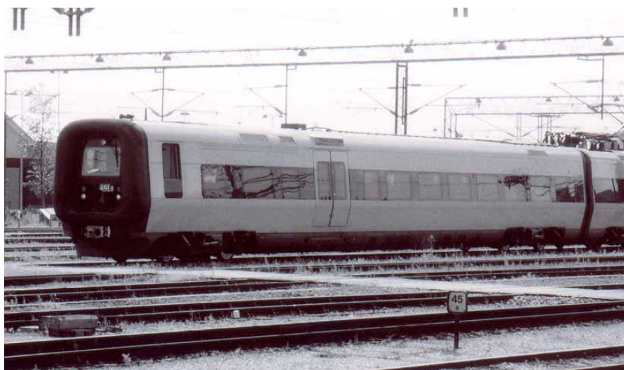
Bild 9 Motorvagnståget X31 på ingång till Helsingör centralstation (Danmark). En X31:a (=3 vagnar) kostar cirka 49 mkr, väger 157 ton och har sth 180 km/h. Den svenska varianten kostar dock 61 mkr (prisnivå 2000). Notera den släta utsidan. Foto: Helsingör, augusti 2004
