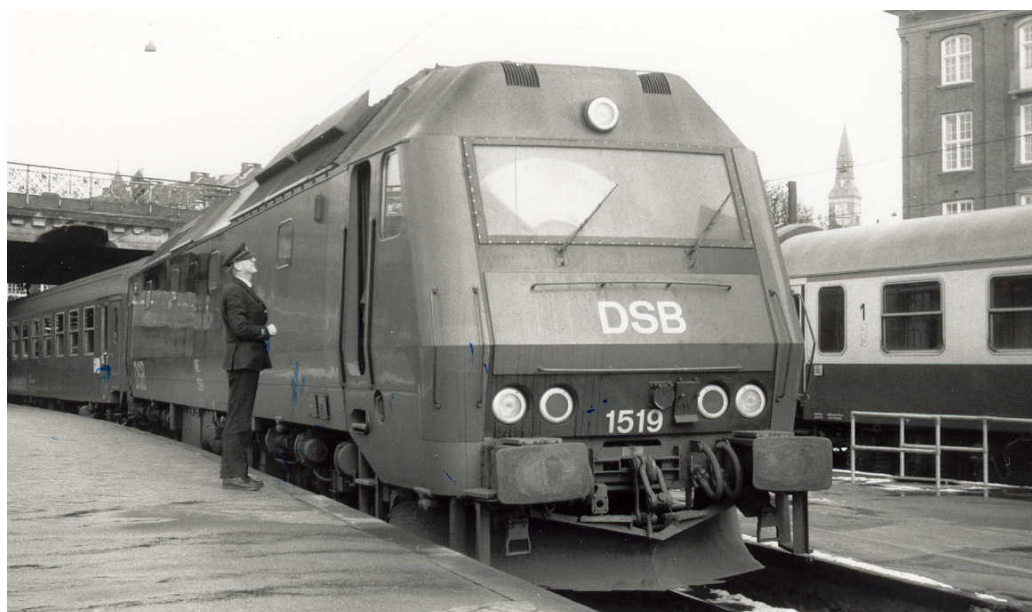
Bild 1 Ett danskt dieselelektriskt lokomotiv av typen ME vid Köpenhamns centralstation. ME-lokomotivet baserar sig till stor del på det norska Di4-lokomotivet. ME-lokomotivet har en största tillåtna hastighet (sth) av 175 km/h och drivs av en kompressormatad tvåtaktsdiesel från amerikanska General Motors. Loket beställdes under 1979. Foto: författaren, Köpenhamn februari 1988
