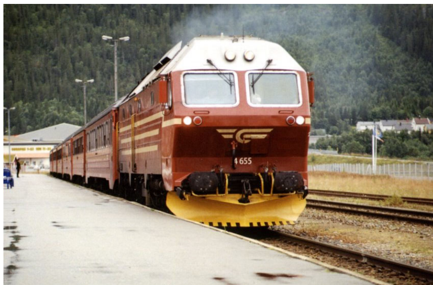
Bild 1B Det norska diesellokomotivet littera Di 4 vid stationen Mo i Rana på linjen Trondheim- Bodö (73 mil). Lokomotivet har mycket stora likheter med det danska lokomotivet ME 1500 men har mjukare infästningar av axelboxarna samt mjukare upphängda drivmotorer, allt för att skona bana och hjulflänsar. Loket är utrustat med den sextoncy lindriga tvåtaktsdieseln 645-E3B från General Motors med effekten 2,4 MW, men är även förberett för den starkare 645-F3 (se även Tabell 3) med effekten 2,8 MW. Di4- serien beställdes under hösten 1978. Foto: www.finnmoller.dk , augusti 2000
