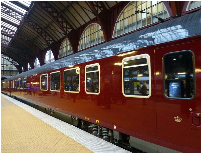
Fig 15. Drottningens personvagn, typ "S", inne på Köpenhamns centralstation. Vagnen är tillverkad av tyska LHB, är 26,40 meter lång, godkänd för 200 km/t och har klimatanläggning. Denna vagn är i själva verket en förebild för nästa generation skandinaviska personvagnar och är i grunden baserad på massproducerade konstruktioner från tysk spårfordonsindustri för höga hastigheter.
