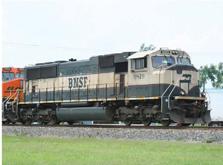
Fig 14. Ett sexaxligt, amerikanskt diesellokomotiv av typen SD 70 MAC. Totalt levererades 1 109 stycken i denna delserie. Loken är utrustade med en GM tvåtakts dieselmotor, boggier med radiellt inställbara hjul och asynkronmotorer. Foto : januari 2008, Terry Cantrell, Wikipedia
