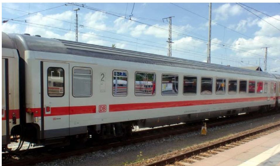
Fig 7. En andra klass fjärrtågsvagn av typen Bpmz 294.5 (f d Bpmz 291), konstruerad för 250 km/t. Vagnserien började levereras till DB senhösten 1978.
