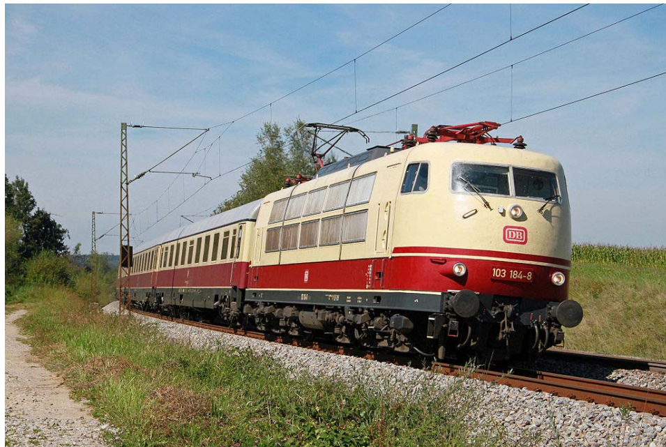
Fig 2. Ett eldrivet fjärrtåg draget av snabbtågsloket 103.1. Normalt var loken endast godkända för 200 km/t men det fanns även en version för 250 km/t. Loktypen har dock uppnått 283 km/t. En vidareutveckling av detta lokomotiv, med topphastigheten 250 km/t, en kontinuerlig toppeffekt på 10 000 kW och kontaktledningsspänningen 15 o 25 kV AC är ett intressant alternativ för framtidens danska tåg.
