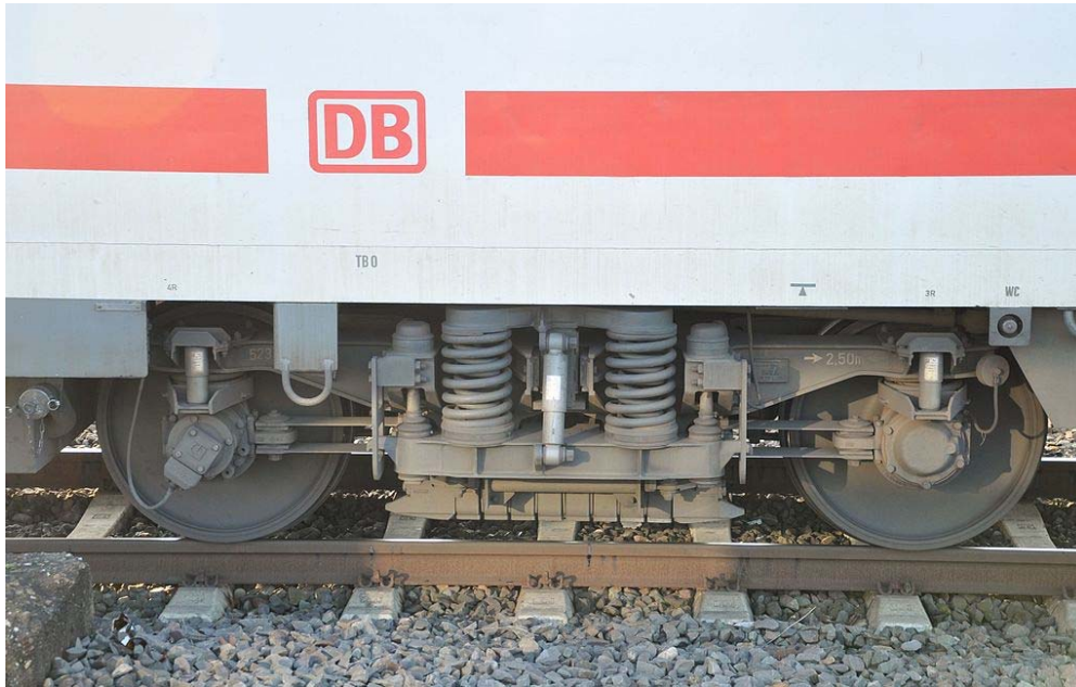
Fig 5. En personvagnsboggi av typen MD 523, som ingår i MD 52- familjen. Notera att boggin saknar blockbromsar. Hos tyska IC-vagnar ("konventionella vagnar") är hastigheten normalt begränsad till 200 km/t men boggin är konstruerad för 250 km/t. MD 52- boggin rullar bland annat i Tyskland, Irak och Saudiarabien. Lägg märke till den karaktäristiska axelboxstyrningen med bladlänkar.
