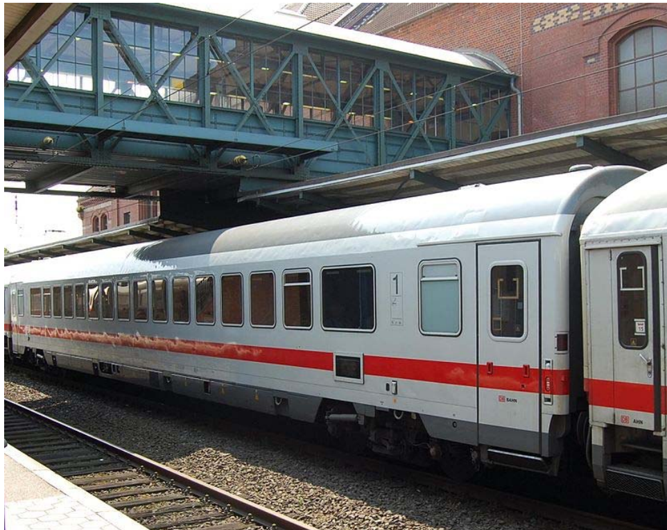
Fig 6. En ombyggd salongsvagn av typen Apmz 127, ursprungligen av typen Apmz 122. Normalt var vagntypen inte godkänd för mer än 200 km/t (MD 36- boggi) men ett färre antal utrustades under 1970- talet med MD 52- boggi för 250 km/t (version 122.2). Apmz 122 började levereras 1975. Vagnen till höger har en lite äldre typ av entrédörr, tidigare vanlig även i Danmark. Den senare är dock inte alls lika trycktät som den vänstra dörren (märks vid snabba tunnelpassager).
