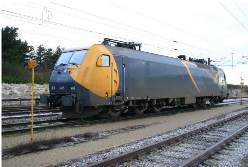
Fig 9. Det danska, sexaxliga elloket EG från Siemens är främst konstruerat för tunga godståg. Med modern kraftelektronik skulle en max kontinuerlig effekt på 10 000 kW och topphastighet 250 km/t vara möjligt. Aerodynamiken måste dock förbättras (inklätt underrede, infällda handtag, rundare front samt renare tak) och boggiernas fjädrar samt svängningsdämpare optimeras. Foto: Manfred E Fritsche, Wikipedia
