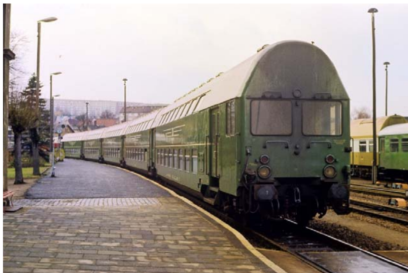
Fig 8. Ett fast sammankopplat (via Jacobs boggier) östtyskt tåg med dubbeldäckare. Östtysklands konstruktioner av dubbeldäckare med dess extremt trånga, ej handikappvänliga inredning är en av de få saker som gått i arv från Östtyskland till Västeuropa, trots socialismens sammanbrott 1990.
